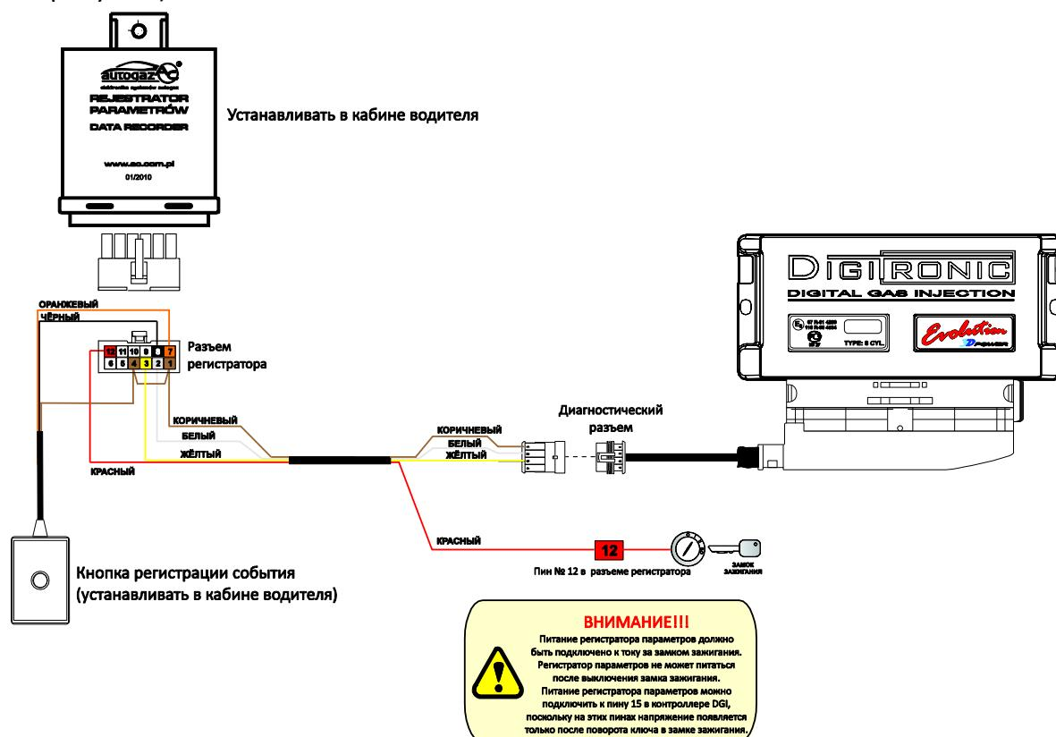
Рисунок 1. Схема подключения Регистратора параметров к установке автомобиля.
